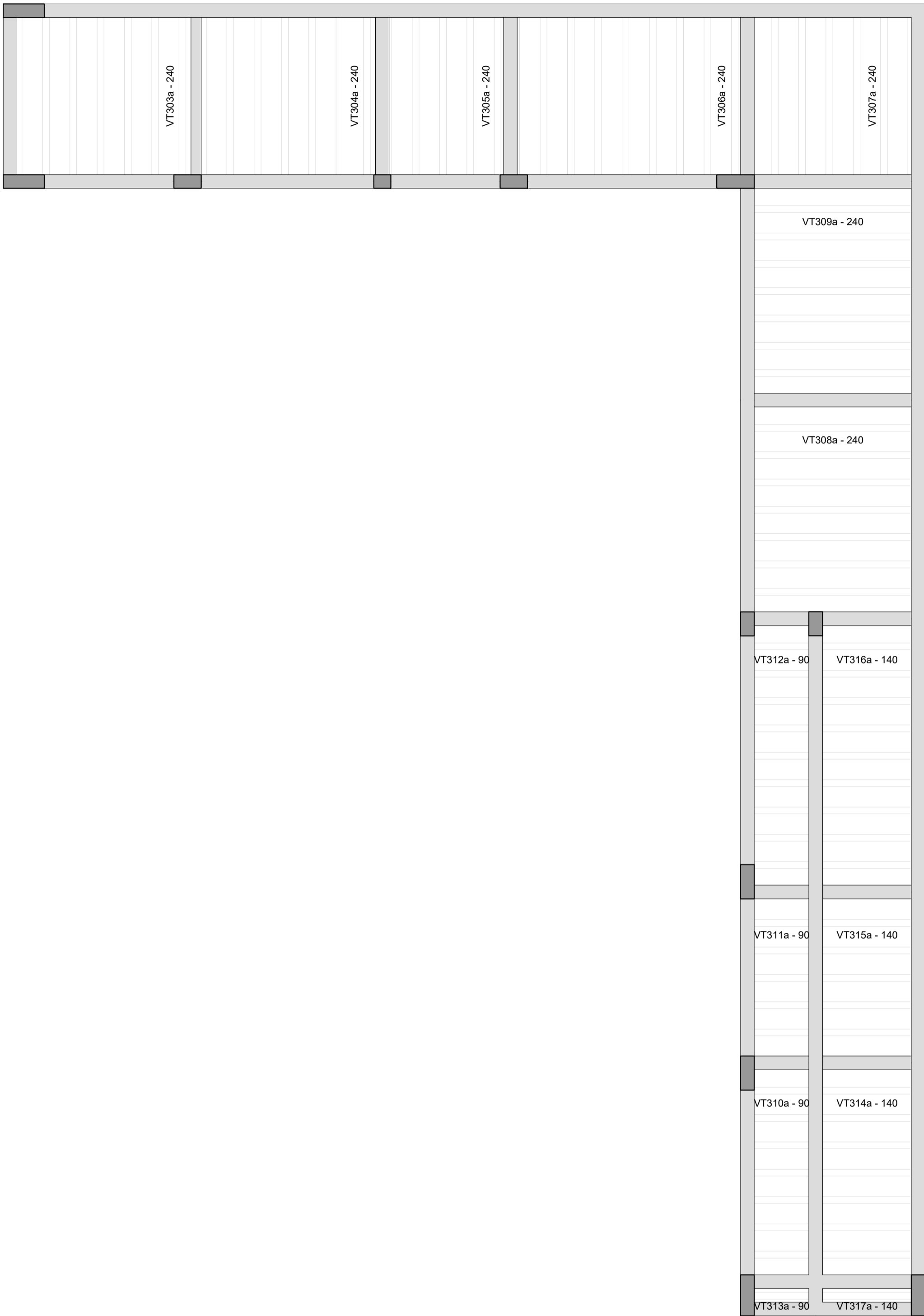
Planta de vigotas pré-moldadas escala 1:50
